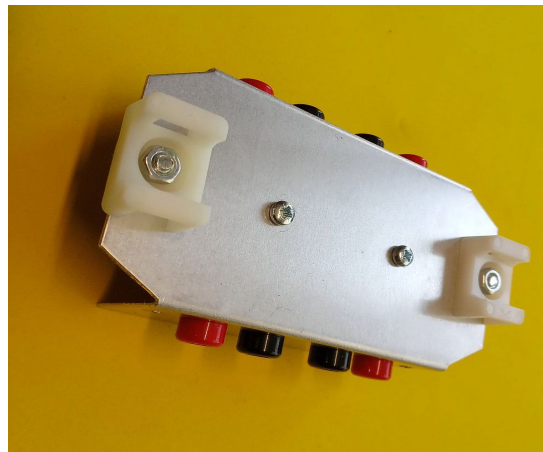
Bodenansicht mit montierten Ösen für die Kabelbindermontage
