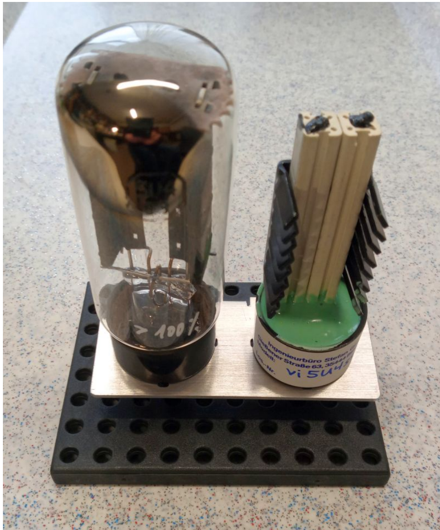
Abbildung: links Gleichrichterröhre 5U4 und rechts ihr Solid-State-Ersatz vi5U4ss
